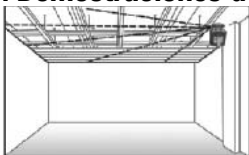
Referencia a plomo para instalación de cielo raso
