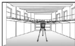
Ligne de référence pour l'installation de rambarde
