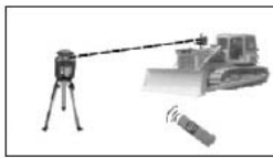
Ligne de référence pour le terrassement
