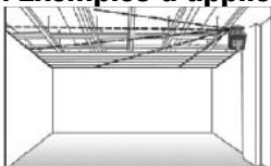
Ligne de référence pour l'installation de plafonds
