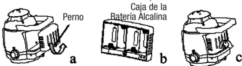
1. Afloje el perno de fijación y retire la caja de la batería de la unidad, como se muestra en la figura a.
