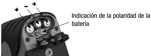
1. Como se muestra en la figura, coloque 3 baterías alcalinas AA en el compartimento de las baterías de acuerdo con la polaridad que se muestra en el compartimento. Cierre el compartimento de las baterías con la tapa. Coloque el interruptor en encendido. Si la luz LED de encendido destella, la batería está baja.
