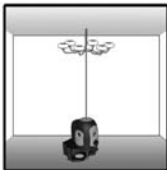
Ligne d'aplomb de référence pour l'installation de plafonniers
