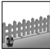
Ligne de référence pour l'installation de clôtures
