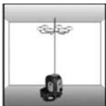
Repère vertical pour l'installation d'une lampe
