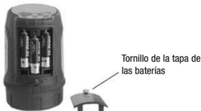
Afloje el tornillo de la tapa de las baterías, coloque 3 baterías alcalinas AA en el compartimiento de las baterías acuerdo con la indicación de polaridad que aparece en él. Vuelva a colocar la tapa de las baterías y apriete el tornillo.
