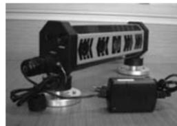
L'affichage à distance 40-6792 est un accessoire optionnel de ce détecteur. Il peut être raccordé au détecteur à l'aide d'un câble. L'installation de l'affichage à distance à l'intérieur de la cabine permet à l'opérateur de voir de près les cinq flèches d'indication au lieu de consulter celles apparaissant sur le détecteur.
