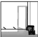
Repère pour l'installation d'un cadre de porte
