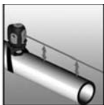
Repère pour l'installation d'un pipeline
