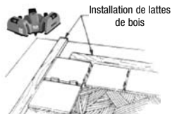
Pose de tuiles
