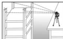
Referencia para la insta- lación de piso de cemento
