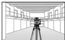
Referencia para la instalación de ventanas
