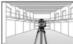
Referencia para la instalación de ventanas
