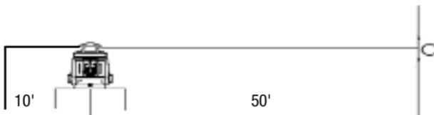
7. Si la distancia entre Y= y Y- es menos de 1/16" en la pared lejana, la unidad se encuentra dentro de un rango de calibración aceptable.
