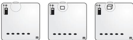
Siga las instrucciones de la línea titilante en la pantalla para medir la longitud, el ancho y la altura. Presione y suelte el botón
