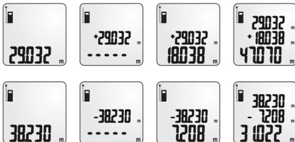
Este medidor láser de distancia tiene la capacidad de adicionar o sustraer cálculos de área, volumen o medición indirecta. Por ejemplo, si usted necesita calcular los pies cuadrados de cuatro habitaciones, este instrumento le permitirá calcular el área total de las cuatro habitaciones
