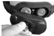
Vuelva a colocar la tapa del compartimiento de las baterías y apriete el tornillo.
